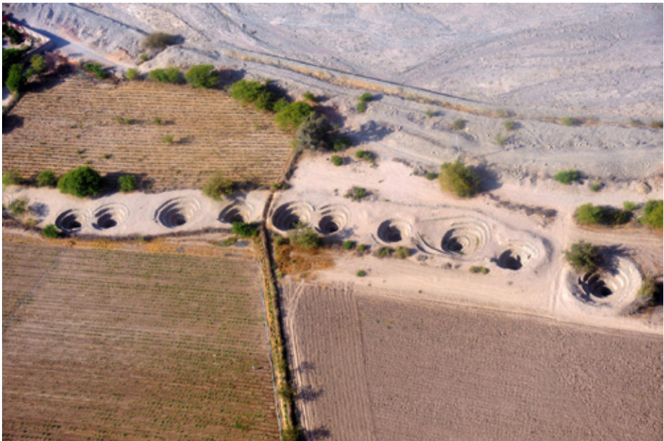
Nasca, acueducto de Cantalloc asociado al río Tierras Blancas. El ducto o galería por el cual fluía el agua filtrante contaba con pozos de inspección y manutención, que se visualizan como espirales descendentes en el suelo, si bien la cronología de estos últimos se discutirá más adelante en el texto. Imagen: https://bit.ly/2Nv7R9B [Acceso: 11.03.2019]
